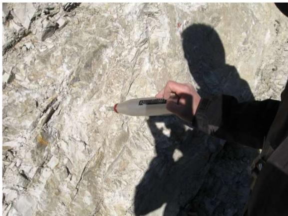
**Fotografia 2.** Misurazione della resistenza a compressione della roccia in corrispondenza dell'area di studio con il martello di Schmidt, noto come sclerometro, ampiamente utilizzato come prova non distruttiva e volta a misurare la "durezza di rimbalzo" della roccia. Dalla prova si ricava l'indice di rimbalzo R che è possibile correlare alla resistenza alla compressione uniassiale mediante la relazione di Irfan e Dearman (1978);
